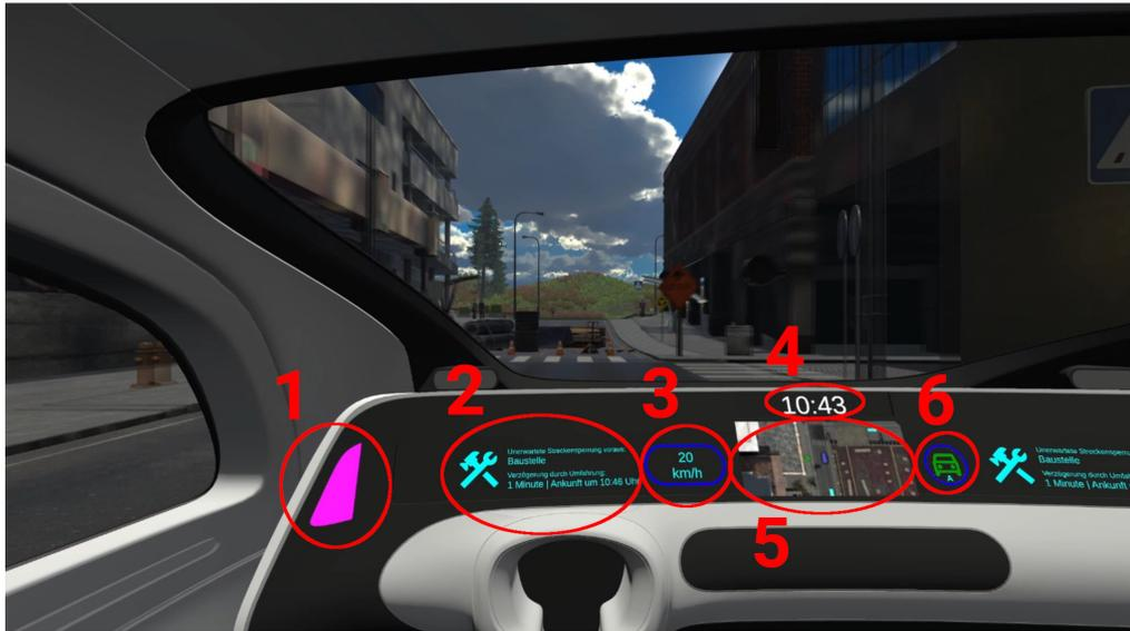
Abbildung 3.3.: 1. Farbige Signal Lichter, 2. Informationen auf dem Armaturenbrett dargestellt, mit großen Symbolen und Text, 3. Aktuelle Geschwindigkeit, 4. Uhrzeit, 5. Karte mit Darstellung der Umgebung, 6. Indikator für autonomes Fahren
